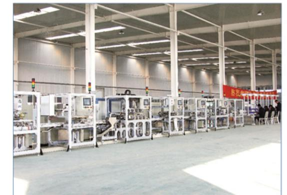
小型断路器全自动生产检测线
