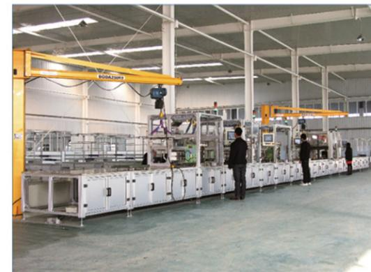
万能式断路器自动生产检测线
